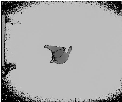
Figura 3.2 Representación de la profundidad obtenida mediante una cámara ToF.
