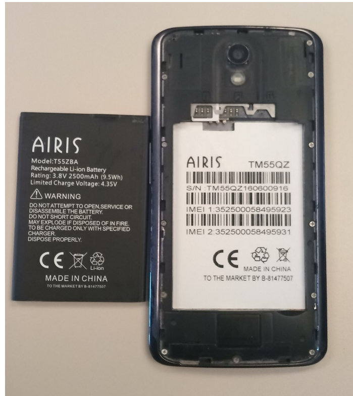
Figura 20: Extracción de la batería y verificación de números de serie
