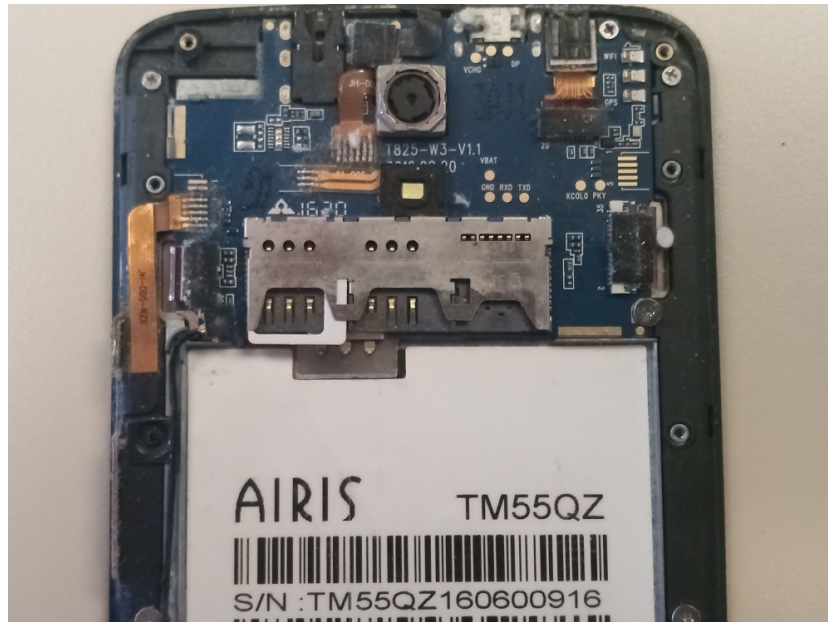
Figura 22: Detalle de la placa PCB de un teléfono AIRIS
