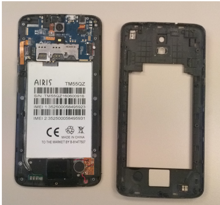
Figura 21: Desatornillamos la carcasa trasera
