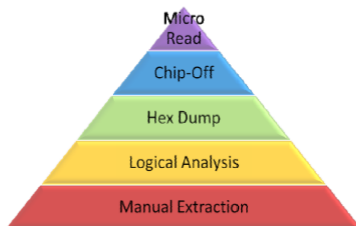
Figura 5: Pirámide de clasificación de herramientas de análisis forense para dispositivos móviles
