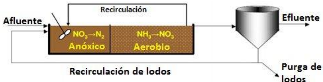
Figura 4. Esquema del Proceso Modificado Ludzack Ettinger (Tomado de Rodríguez, 2016).
