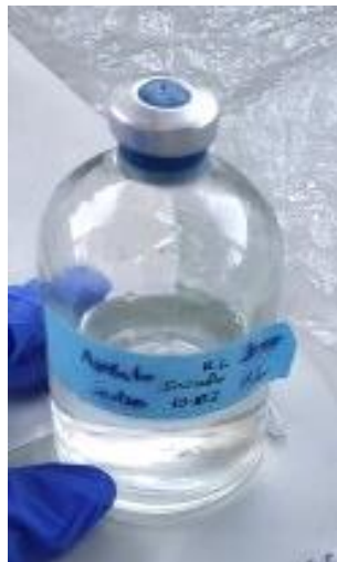
Figura 10. Bote pequeño donde se realizan los cultivos, sellado con septum de butilo.
