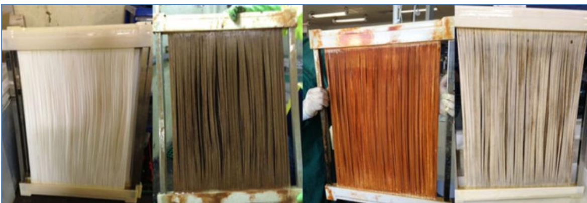
Figura 8. De izquierda a derecha: membrana virgen, membrana sucia, membrana tras limpieza con NaOCl y membrana tras limpieza con ascorbato. Fuente: Wang et al. , 2014.
