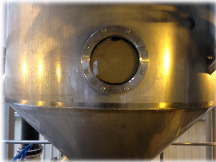
Detalle visor de la parte intermedia de reactor. Fuente: elaboración propia.
