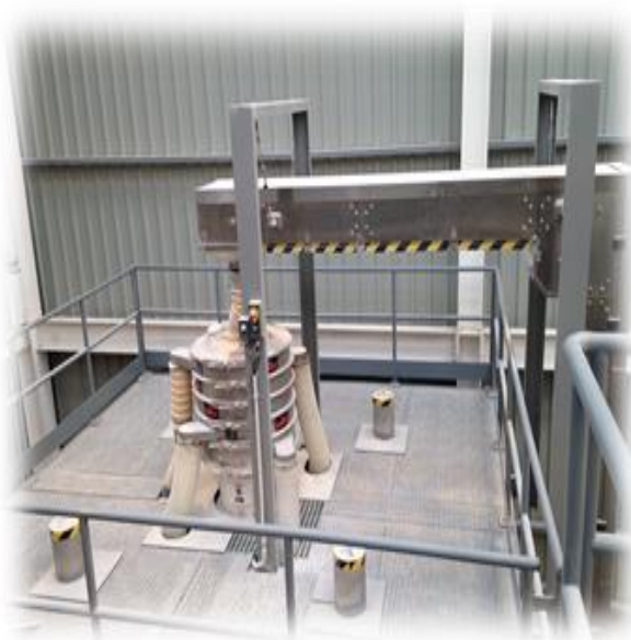
Figura 16: Tamiz clasificador. Fuente: elaboración propia.
