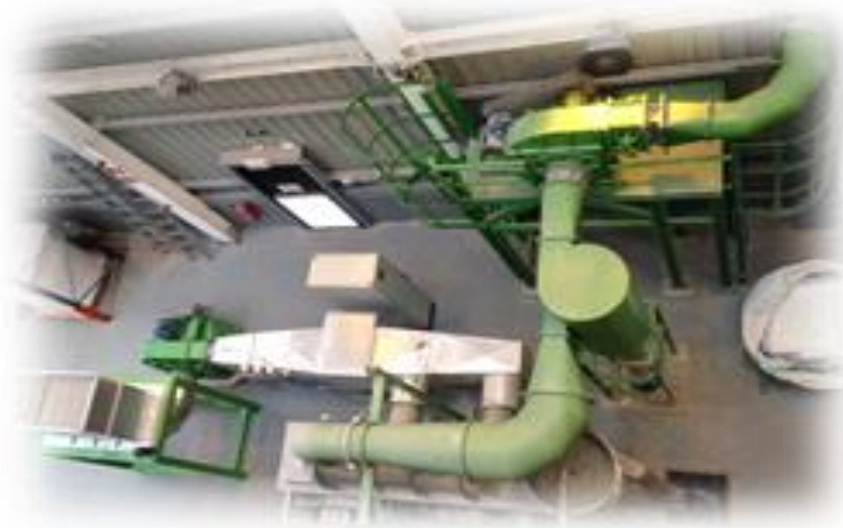
Figura 15: Sistema de deshidratación. Fuente: elaboración propia.
