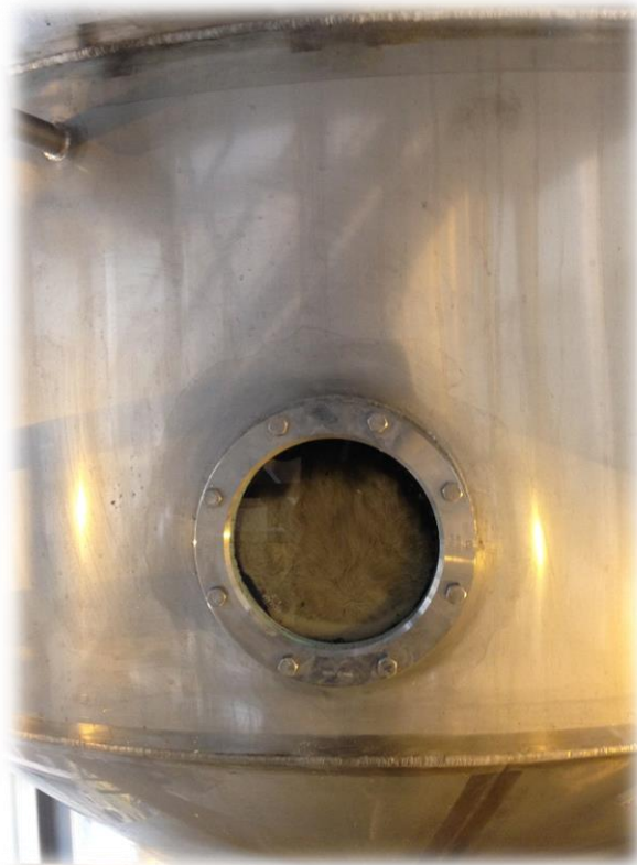
Visor de la parte intermedia de reactor. Fuente: elaboración propia.
