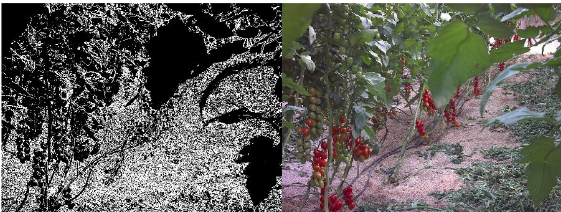
Imagen 30: Detector de bordes con el método Prewitt.
