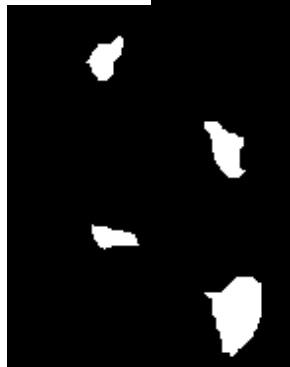
Imagen 18: Visualización de la región seleccionada (a, d, g, j), máscara resultante después de binarización con un umbral superior de matiz del 20% (b, e, h, k) y máscara resultante después de binarización con un umbral inferior de matiz del 95% (c, f, i, l).
