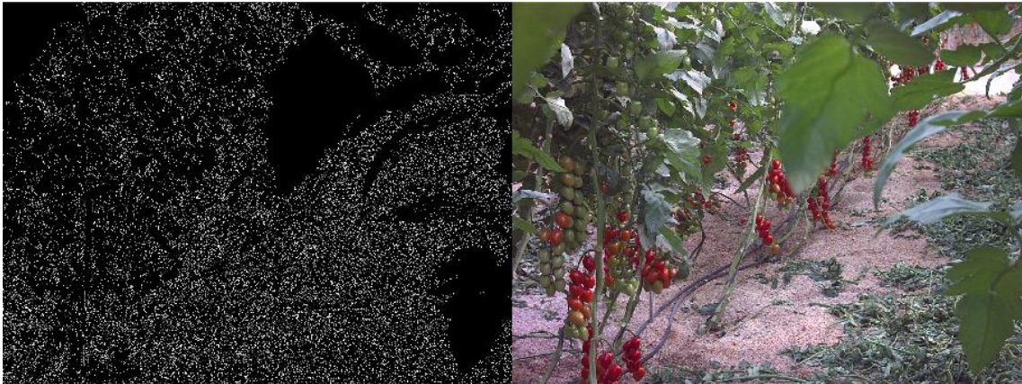
Imagen 27: Detector de bordes con el método Canny.
