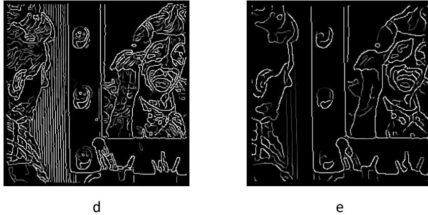
Figura 25: Visualización de la imagen de entrada (a) después de pasar por el filtro Canny: (b) Filtro gaussiano con desviación ( \sigma ) 1, umbral superior ( T_1 ) fijado en valor 255 y umbral inferior ( T_2 ) situado en 1; (c) \sigma = 1 , T_1 = 255 y T_2 = 250 ; (d) \sigma = 1 , T_1 = 128 y T_2 = 1 ; (e) \sigma = 2 , T_1 = 128 y T_2 = 1 .
