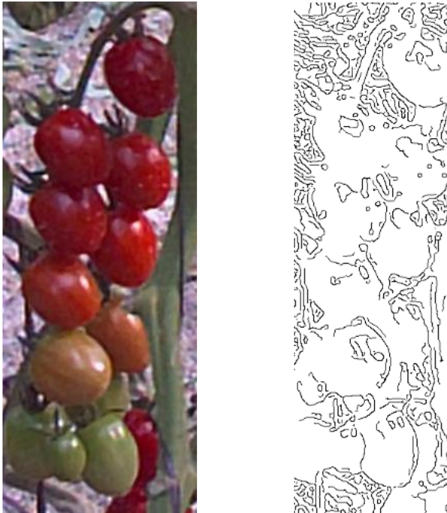
Imagen 31: Aplicación del método Canny en imagen centrada en rama.
