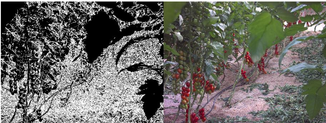
Imagen 28: Detector de bordes con el método Sobel.
