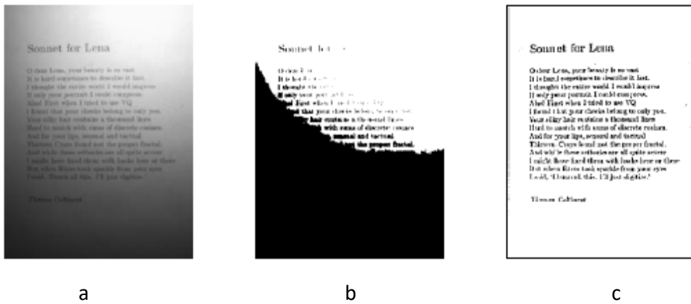
Imagen 5: Original (a), con umbralización global (b) y con umbralización local (c).
