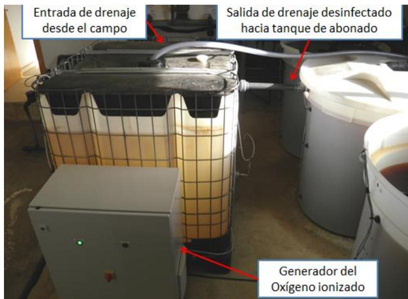
Figura 11 - Sistema de Oxígeno Ionizado
