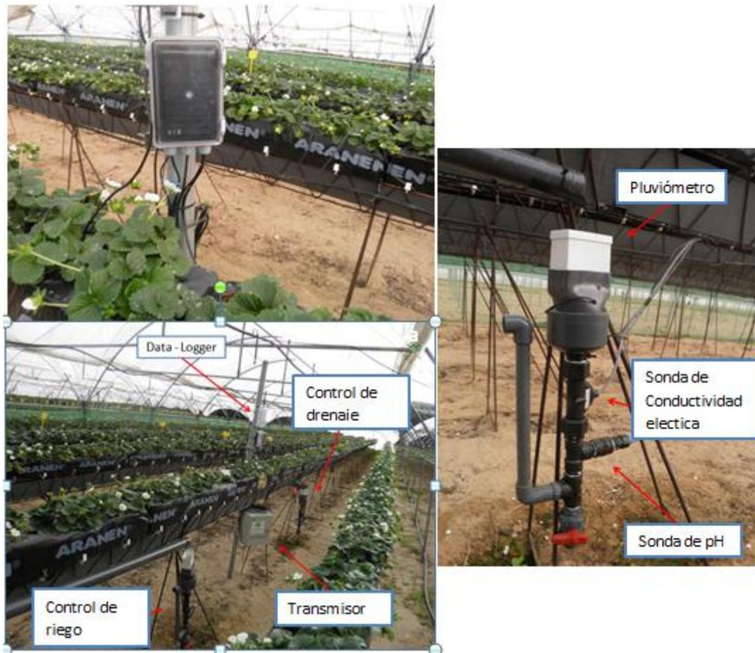
Figura 4- Estación control .Kit de control
