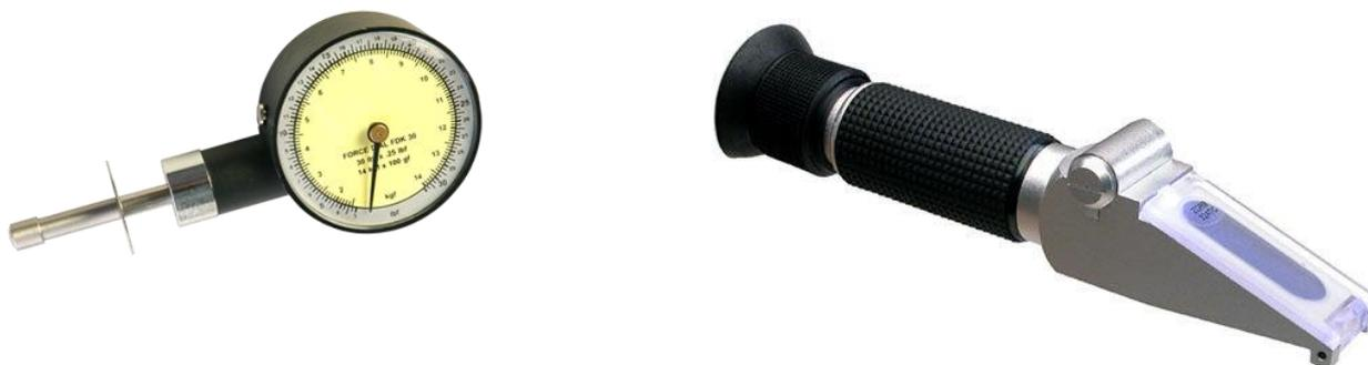
Figura 14 - a. Penetrometro b. Refractometro
