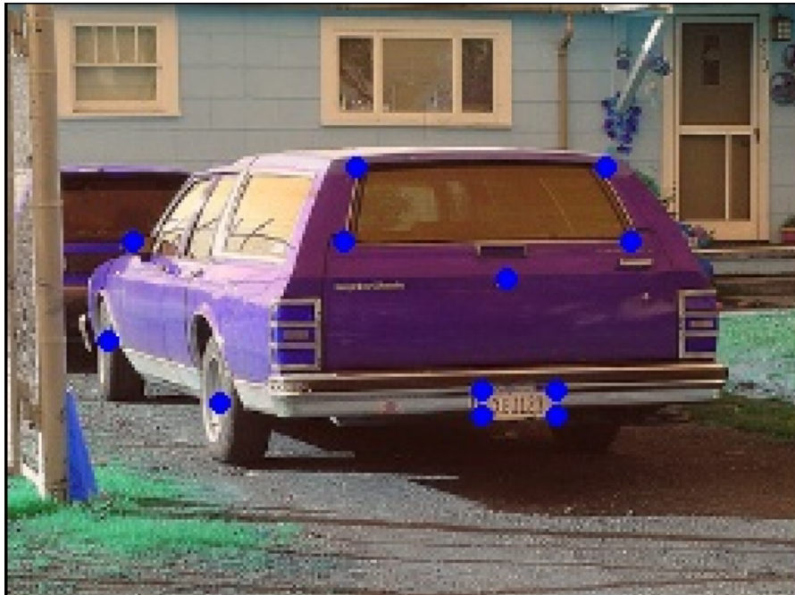
Figura 5.12: Ejemplo de etiquetado con red HRNet48.
