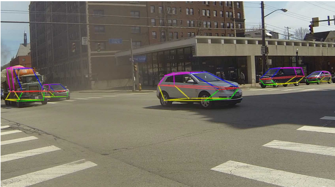
Figura 2.18: Ejemplo de la red neuronal de OpenPose utilizada sobre imágenes de vehículos. Figura obtenida de [57].
