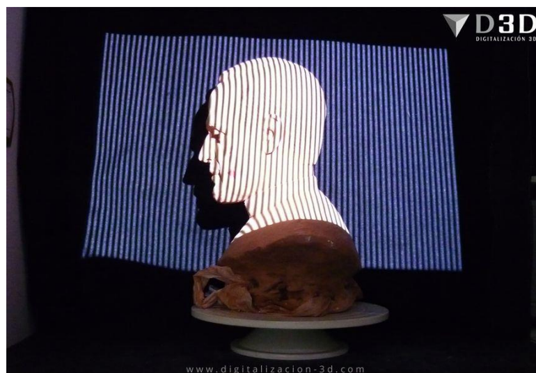
Figura 11 Proceso de escaneo 3D. Patrón de luz emitido sobre el busto (7)
