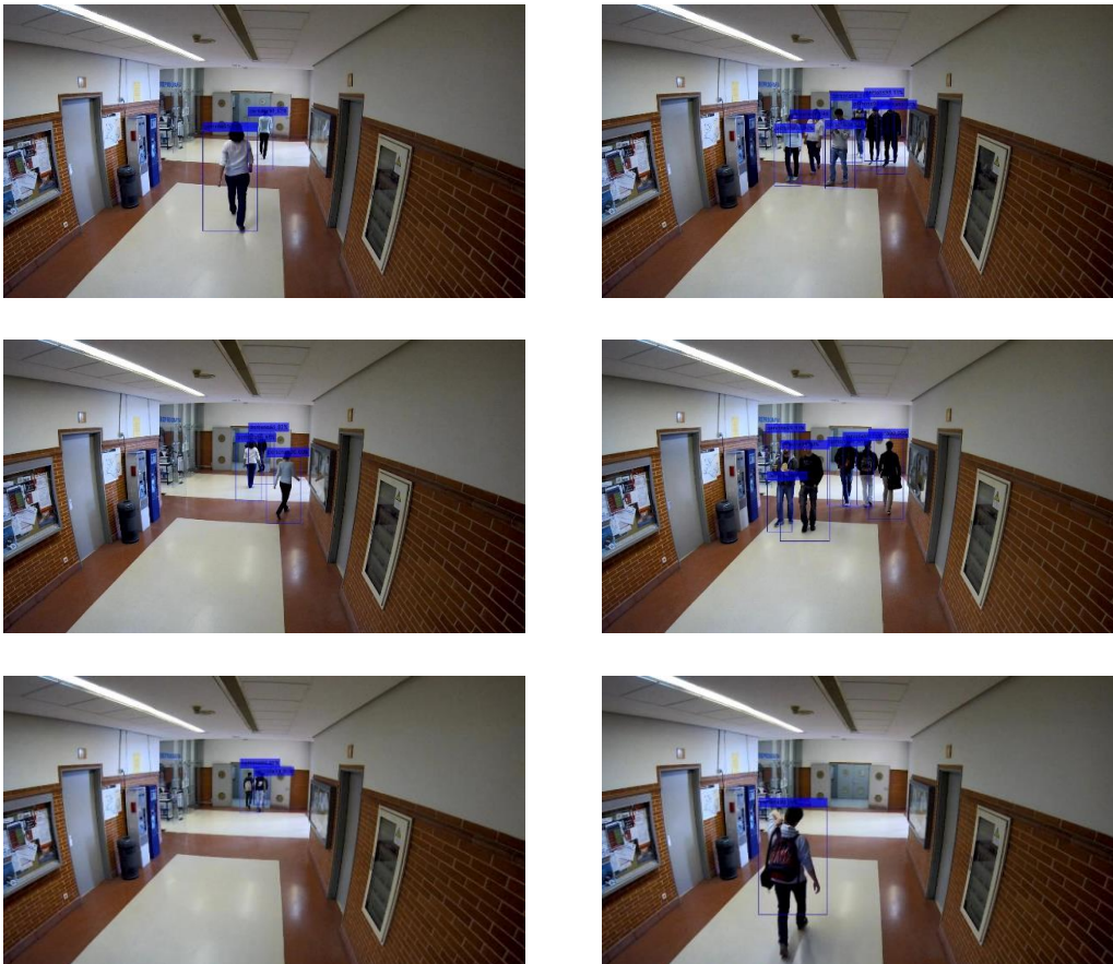
Figura 57 Resultado de ejecutar el detector de personas del 2º entrenamiento sobre un video de prueba
