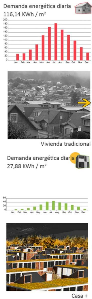
Figura 6. Comparativa de demandas energéticas entre una vivienda ajustada a la Normativa chilena de la zona y la vivienda CASA+
