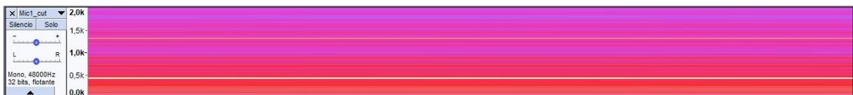
Figura 4.14: Espectrograma de señal de 440 Hz.
