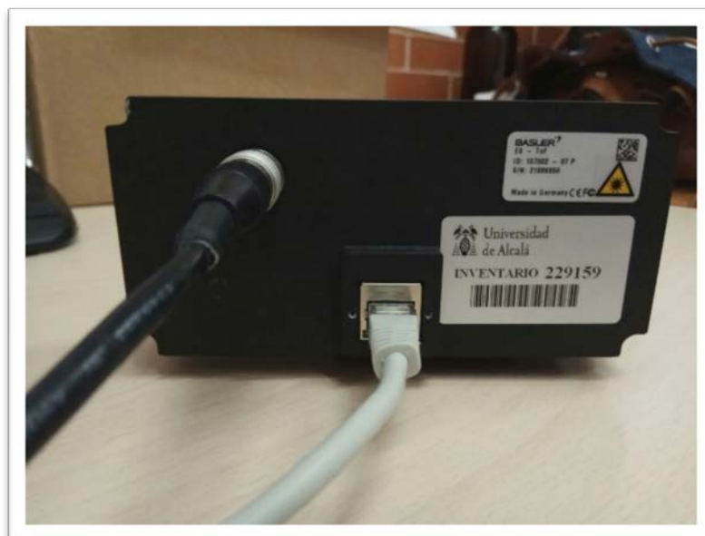
Figura 30. Conexión de la cámara
