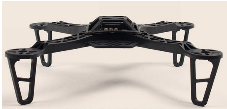
Figura 3.7: Frame de 250 mm con tren de aterrizaje.
