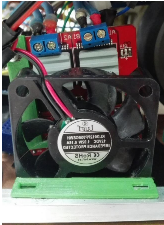
Figura 44. Ventilador con tarjeta de potencia
