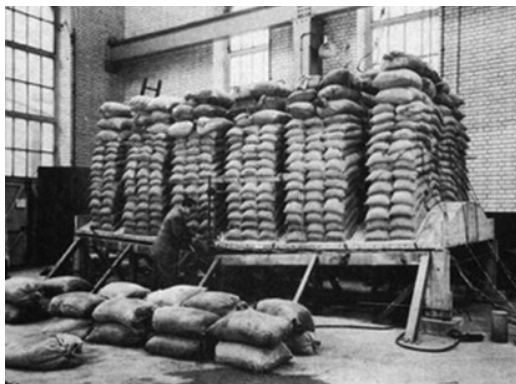
Figura 3 Puesta en carga de un modelo de cáscara cilíndrica larga. (Morice 1952)
