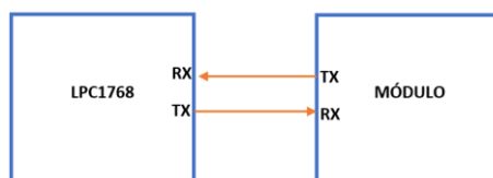
Figura 3. Conexión de comunicación serie asíncrona.
