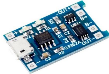
Figura 47. Módulo de carga de baterías.
