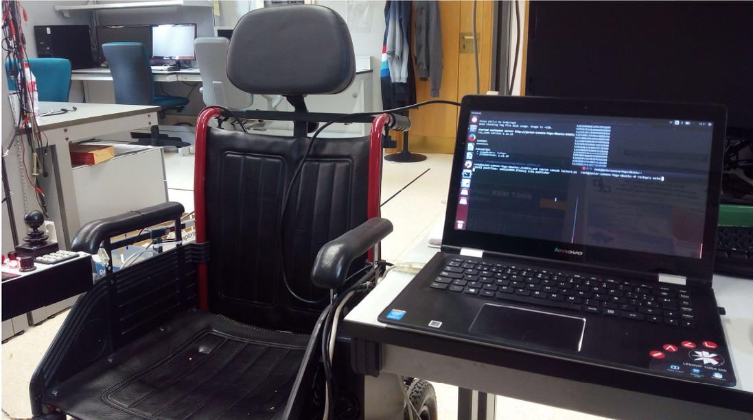
Figura 34 – Fotografía de SARA conectada a través del puerto USB al PC.
