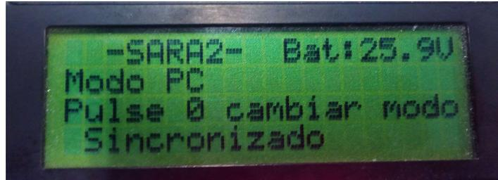
**Figura 39 - Mensaje “Sincronizado” de SARA cuando detecta comunicación con el nivel alto (PC).**
