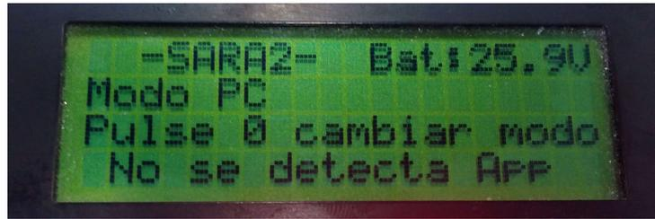
Figura 37 – Mensaje “No se detecta App” de SARA cuando no existe comunicación con el nivel alto (PC).
