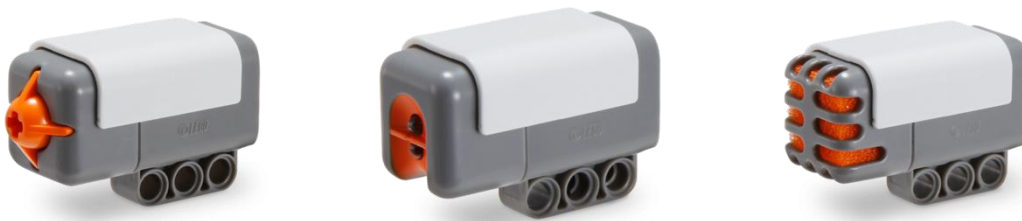
Figura 11. De izda. a dcha. sensores de contacto, luz y sonido del NXT [22] [23] [24]
