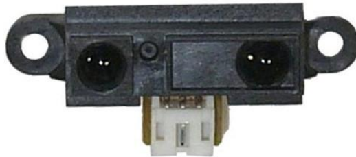
Figura 32. Sensor reflexivo GP2D12 [38]
