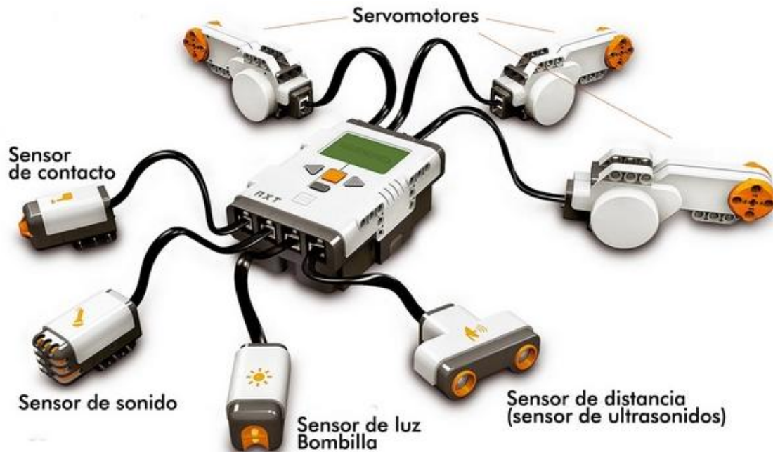
Figura 5. Brick, sensores y actuadores del kit LEGO Mindstorms NXT [14]
