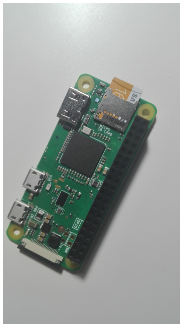
Figura 5.12: Instalación de la tarjeta micro SD en la placa del dispositivo.
