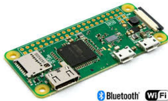
Figura 2.9: Raspberry Pi modelo Zero W.[2]
