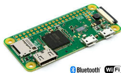
Figura 4: Raspberry Pi modelo Zero W.[2]
