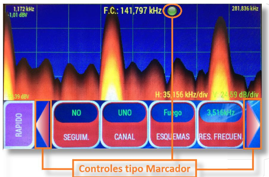
Ilustración 4.14: Apariencia del control Marcador en este proyecto
