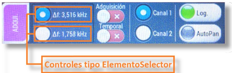
Ilustración 4.15: Apariencia del control ElementoSelector en este proyecto
