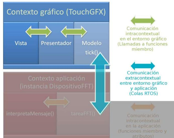
Ilustración 4.65: Detalle de la comunicación del entorno gráfico con la aplicación
