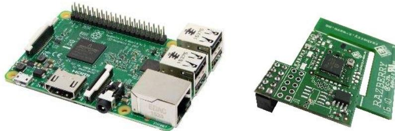
*Figura 19. Raspberry Pi 3 Model B y módulo Z-Wave RazBerry*
