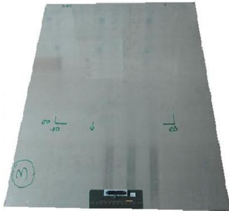
Figura 19. Panel "3" de aluminio Al T3 2024, típicamente aeronáutico, de medidas 1mm x 480mm x 580mm, con un array de transductores piezoeléctricos adherido, sobre el que se han realizado diferentes ensayos de los que se dispone varios archivos de datos de adquisición.
