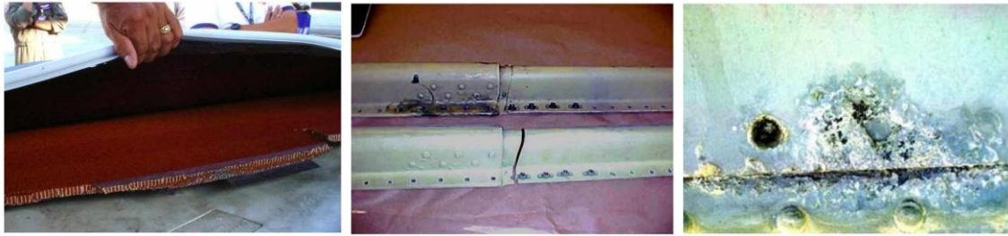
Figura 2. Ejemplo de daños en estructuras aeronáuticas: despegado, fractura y corrosión.
