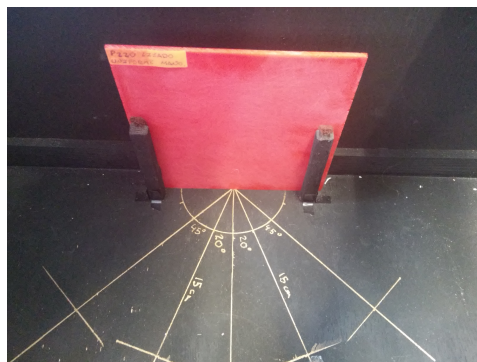
Figura 3.4: Interior de la caja de obtención de las imágenes de moteado.
