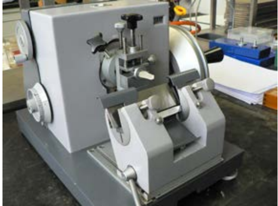
Figura 14. Microtomo utilizado en el corte seriado del ejemplar.
