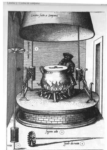
1. Molinete de humo. 2. Fogn alto. 3. Rueda. 4. Espeto que se articula con la rueda.
