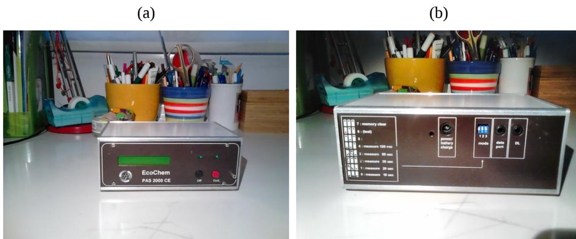
Figura 1: Imagen del sensor PAS2000CE. a) Imagen frontal, b) Imagen de la parte posterior.
