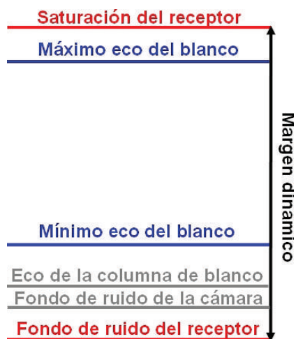
Figura 2.4: Niveles de potencia relativa que afectan a la precisión de las medidas
