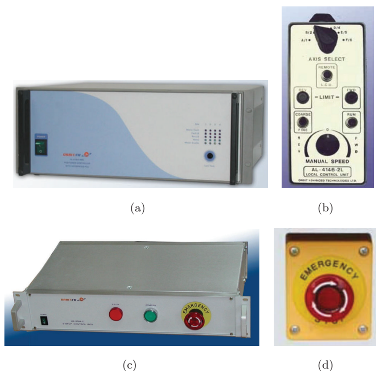
Figura 3.13: Equipos de control de los posicionadores: (a) Controlador (b) Unidad local, LCU (c) Equipo de parada de emergencia (d) Botón de pánico
