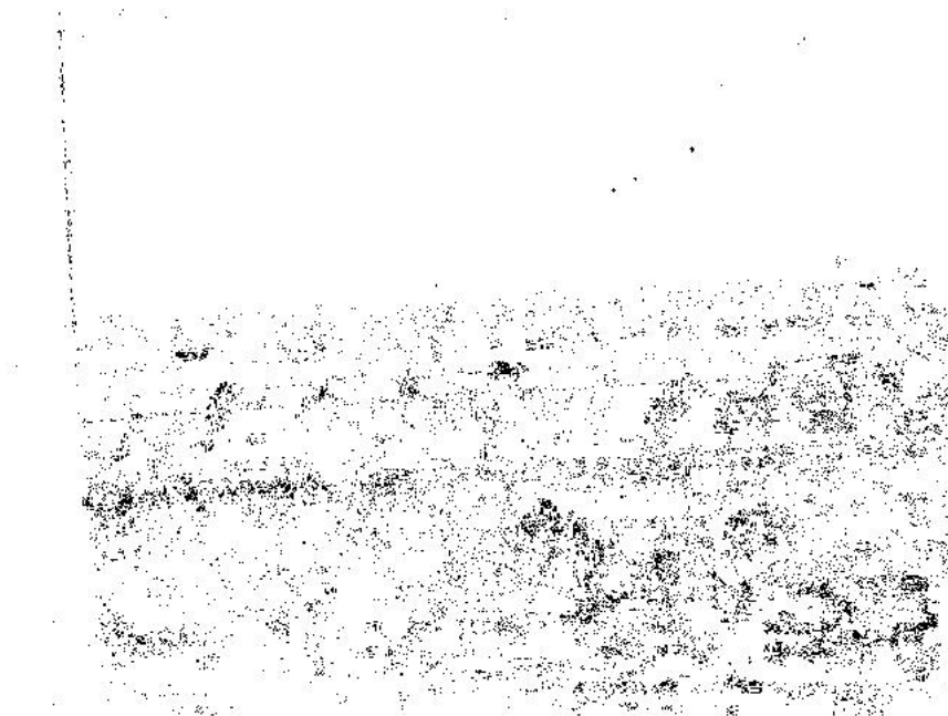
Figura 2.3: Efecto de un umbral demasiado bajo en el cálculo de la máscara de movimiento.
